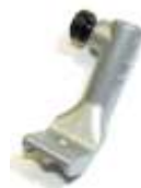
Art.-Nr.13715 Herst.-Nr.12393/5 Kederfuß innen Doppelkeder für Pfaff/Adler 5mm Für Doppelkedarbeiten. Passend für Pfaff Kl. 145, 335, 545, 1245, 1425, 1525 und Adler 67,167, 467, 767
